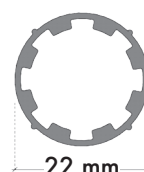
Coupe de l'axe d'enroulement
